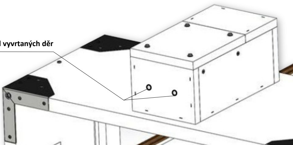
Příklad umístění otvorů ve stěně ochranné skříně, bez předem vyrobené drážky
